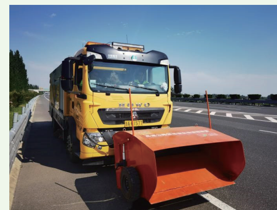
高速公路路面垃圾快速捡拾收集装置
